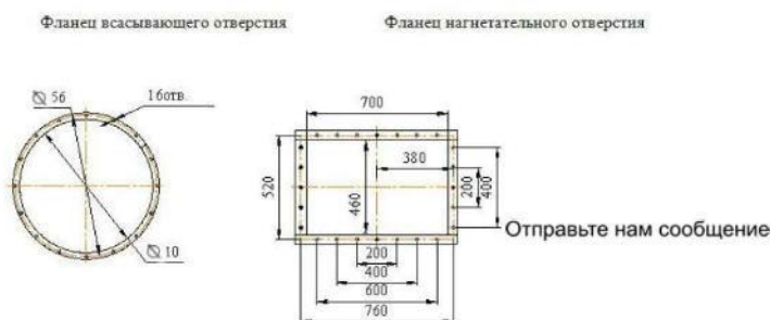
Рисунок 2.3 Вентиляторы ВРП-100-45-10. Присоединительные размеры
